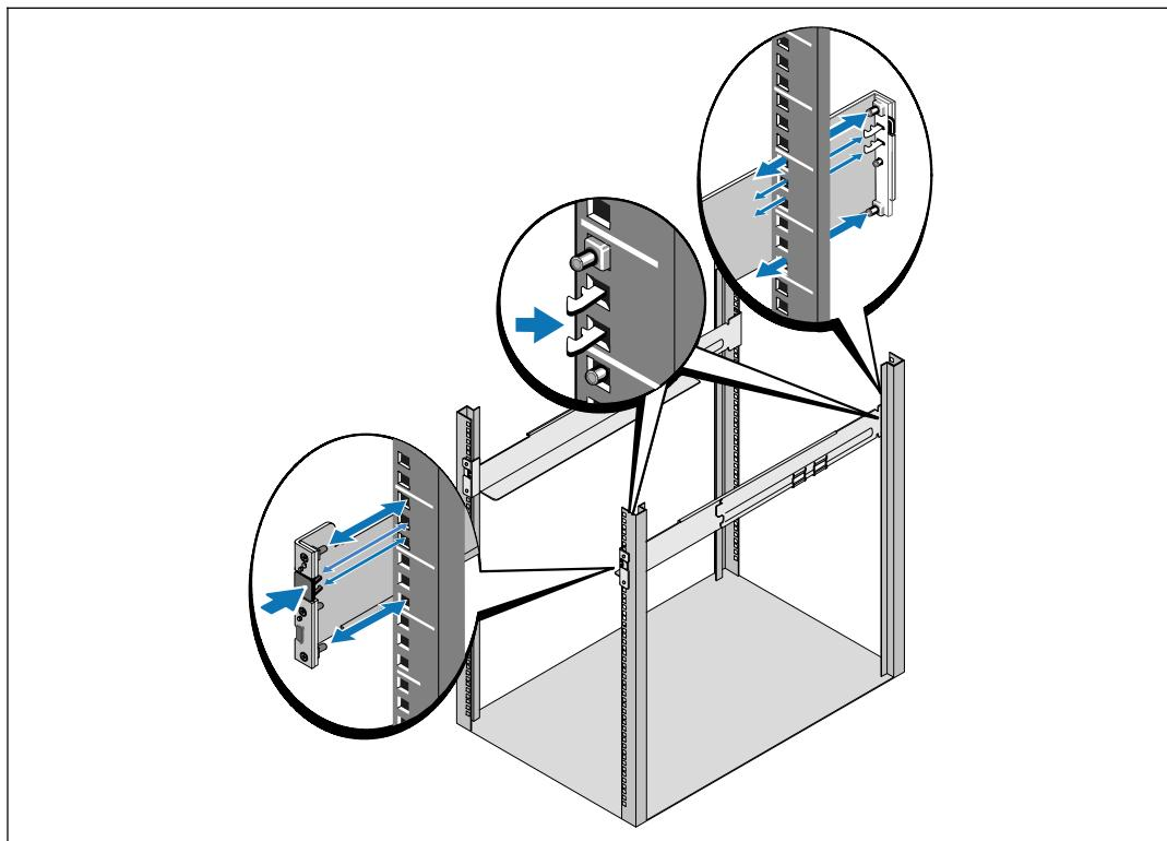
**!** 注意：方孔机架和无螺纹的圆孔机架的操作说明相同。 导轨适用于这两种机架。
