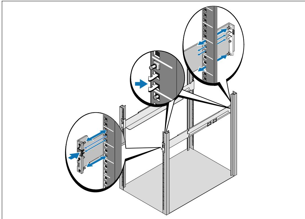
**참고:** 사각 구멍 랙과 나사산 없는 원형 구멍 랙에 대해 설치 지침은 동일합니다. 레일은 두 종류의 랙에 모두 맞습니다. 원형 구멍 랙은 그림에서 볼 수 있습니다.
