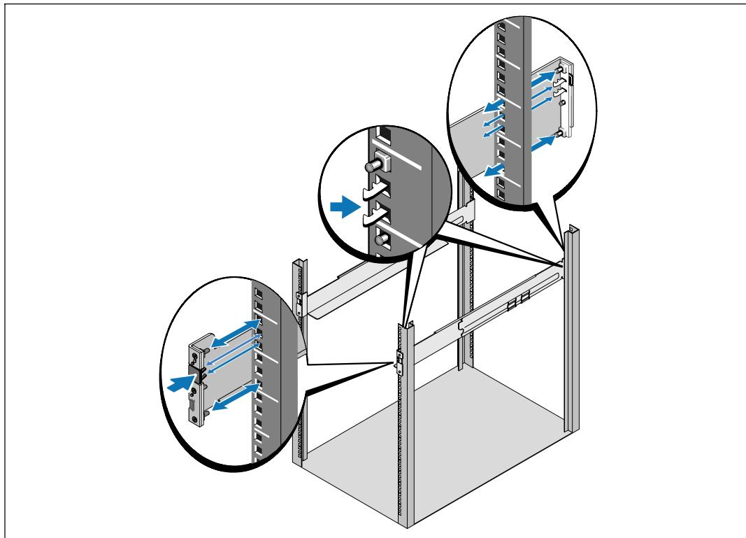
**NOTA:** Las instrucciones son las mismas que para los bastidores de orificios cuadrados y los bastidores de orificios redondos y sin rosca. Los rieles sirven para ambos estilos de bastidores. En las ilustraciones se muestra el bastidor con orificios redondos.
